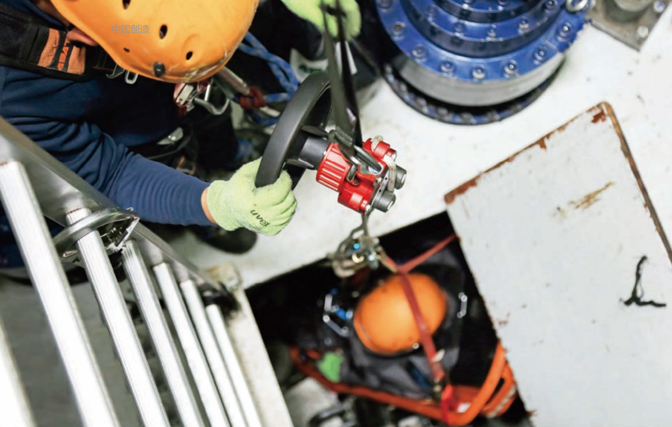
高空速降器 Automatic descending device
